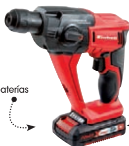
TALADRO PERCUTOR A BATERÍA TE-CD 18-2 Li Batería Li-Ion Voltaje 18 V.D.C. Capacidad 1.500 mAh. 2 Velocidades: 1º 0 - 320 min-1 / 2º 0 - 1.350 min-1. Par de apriete 23 + 1. Tiempo de carga aproximado 30 minutos. Fuerza 46 Nm. Electrónico. Luz LED. Incluye maletín de alta calidad.
