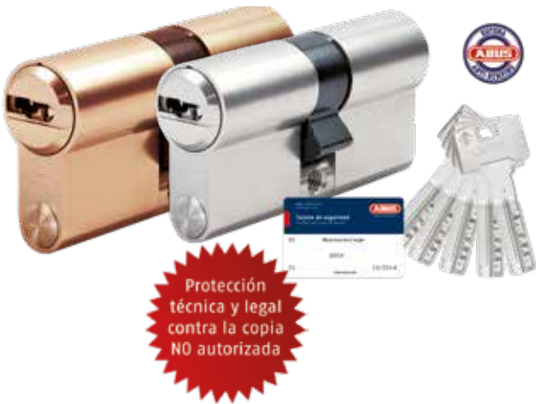
CILINDRO SEGURIDAD INCOPIABLE CON PUENTE DE ACERO ABUS Sistema Inspect resistente al bumping, protección anti-taladro con pasadores de acero endurecido y llave de alpaca de cuello largo. Alta seguridad y flexibilidad con puente de acero.
