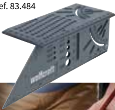
ESCUADRA 3D Esta herramienta de marcado permite tomar medidas fácilmente y transferirlas a vigas, piezas de trabajo tridimensionales. Con tope para ángulos de 45° y 90° y un transportador de ángulos entre 0-90°. Proporciona un indicador para líneas paralelas. También equipado con un calibrador de diámetros.
