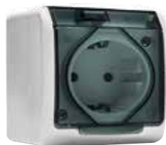
BASE CON TOMA DE TIERRA LATERAL ESTANCO Base con toma de tierra de superficie 16 A 250 V. Grado de estanqueidad IP54. 6,00 Ref. 83.214
