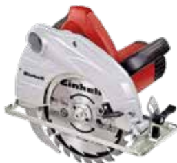
SIERRA CIRCULAR TC-CS 1400/1 EINHELL Potencia 1.400 W, 4.800 rpm. Profundidad de corte a 90°: 65 mm. Profundidad de corte a 45°: 45 mm. Disco de sierra: diámetro 190 x 20 x 2,5 mm. 24 dientes.
