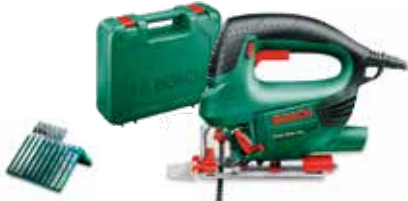
SIERRA DE CALAR PST 800 PEL + SET BOSCH 530 W. 500-3000 cpm. Sistema SDS. Conexión para aspiración. Función de soplado. Empuñadura Softgrip. Bajas vibraciones. Longitud de corte: madera 80 mm, acero 5 mm. Cut control y movimiento pendular de 4 niveles. 1 hoja de sierra de calar para madera (T 144D). Protección contra astillas. Cubierta protectora transparente. Gratis set con 10 hojas de sierra.
