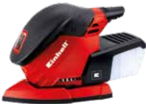
LIJADORA MULTI TE-OS1320 EINHELL 130 W. Oscilaciones 24.000 min-1. Circuito de oscilaciones -ø: 2.0 mm. Posibilidad de conexión a sistema de extracción de polvo, softgrip. Incluye 3 lijas de papel.
