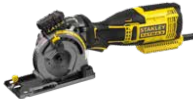
SIERRA CIRCULAR DE MANO FME380K-QS STANLEY 650 W. Diámetro 89 mm, velocidad 4.500 rpm, guía láser, profundidad de corte 28,5 mm (madera), 8 mm (baldosas) y 3 mm (aluminio). Incluye 3 discos de corte (madera, diamante y metal) y maletín.
