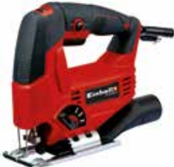
SIERRA DE CALAR ELECTRÓNICA TC-JS 80/1 EINHELL Potencia 550 W, acción pendular, velocidad: 800-3.000 min-1; profundidad de corte: madera 80 mm, hierro 10 mm, plástico 20 mm; corte diagonal: máx. 45°.
