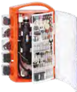
KIT MINI TALADRO CON 350 ACCESORIOS 141 W. Dotado de llave mecánica, tuerca y 5 pinzas surtidas (Ø 1,6-2,35 x 2-3,0-3,2 mm) 350 accesorios surtidos. Árbol flexible 110 cm.
