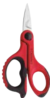
TIJERA ELECTRICISTA 3 CLAVELES Acero Inoxidable. Filo Microdentado. Gran poder de corte, incluso para cables gruesos. Mangos aislantes. 6".
