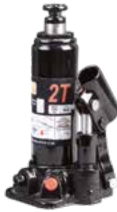
GATO DE BOTELLA Carcasa roscada a la base. Condiciones de trabajo: -20° hasta 70°. 2, 4 o 6 toneladas.
